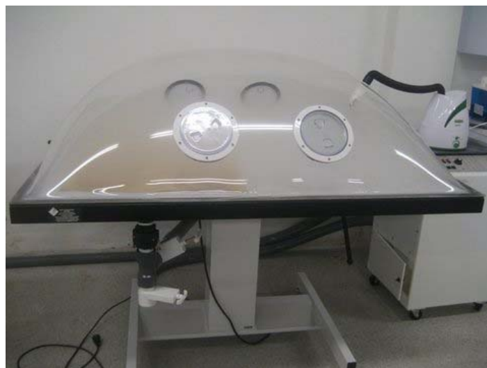
Mesa de succión y cámara de vapor frío
